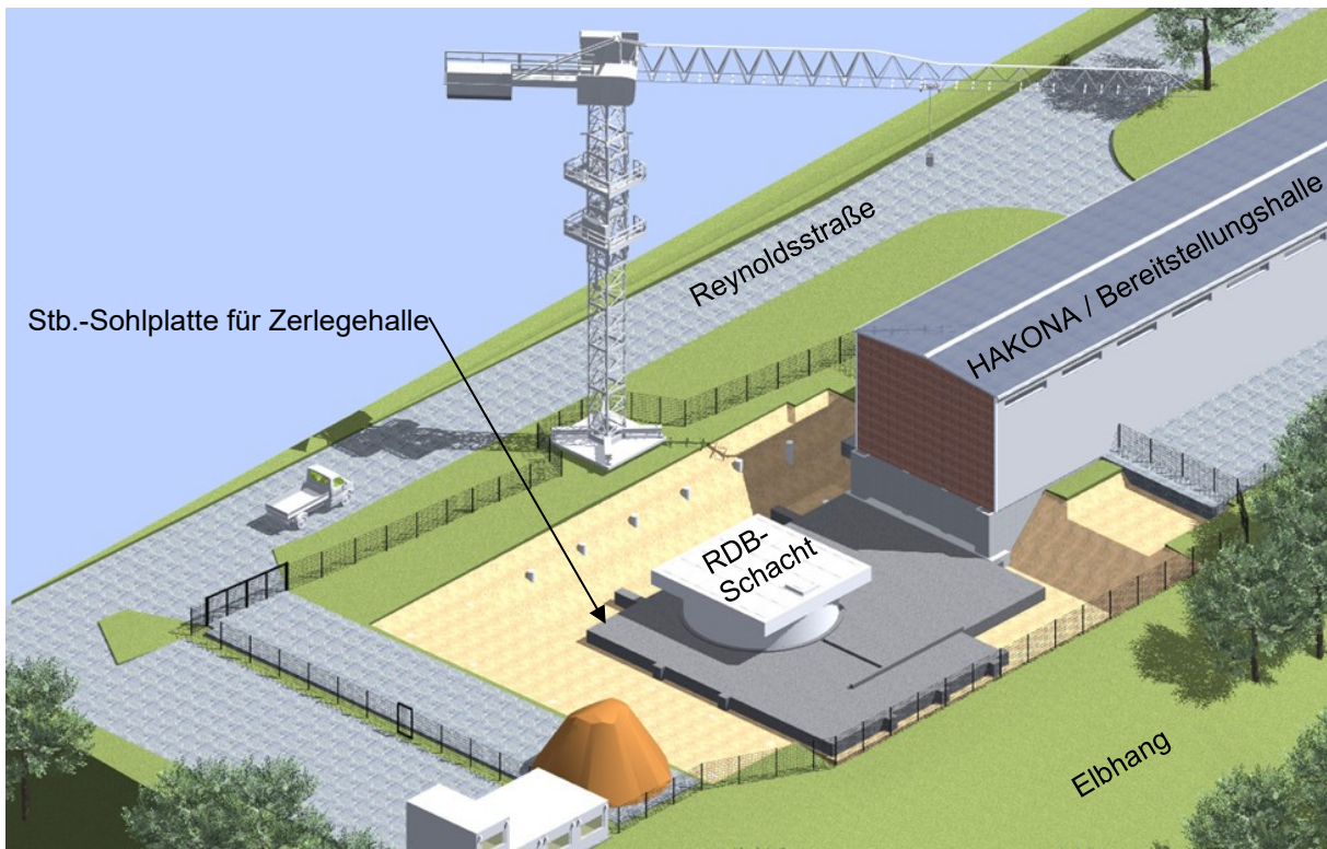
Abbildung 2-6: Herstellung der Fundamente des tieferen Hallenteils
