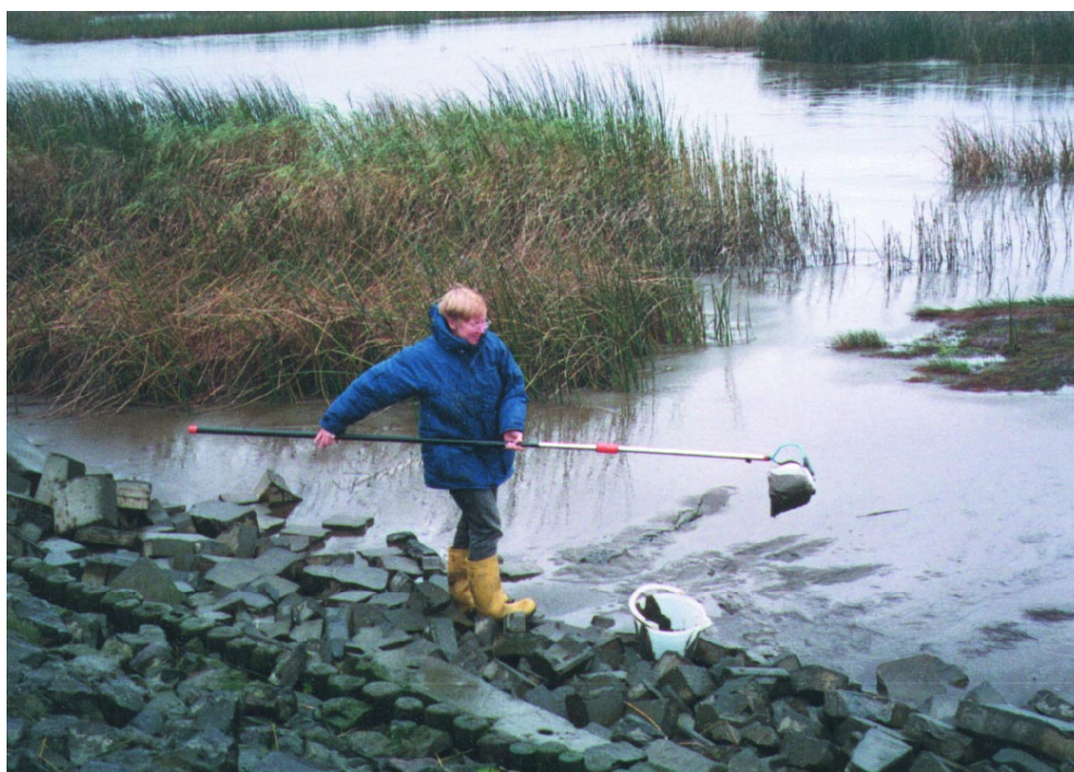
Abb. 3.4: Sedimentprobennahme mit dem modifizierten Flachgreifer
