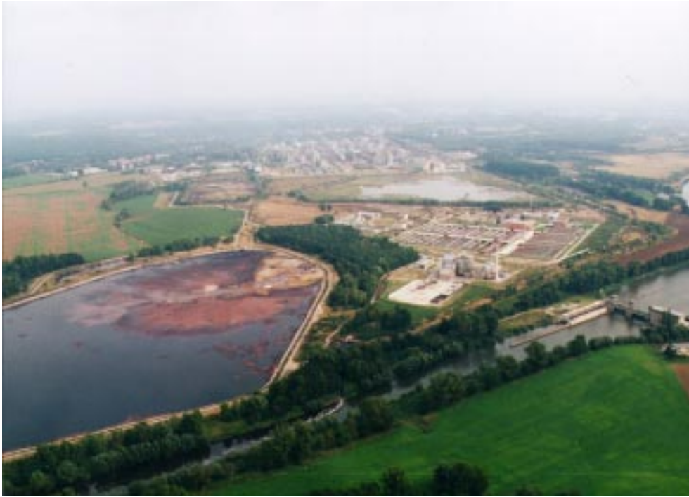
Abb. 2.5: Chemiekombinat Synthesia bei Pardubice mit neuem Klärwerk, Absetzbecken und Einleitungen in die Elbe (tschechische Elbe-km 233)
