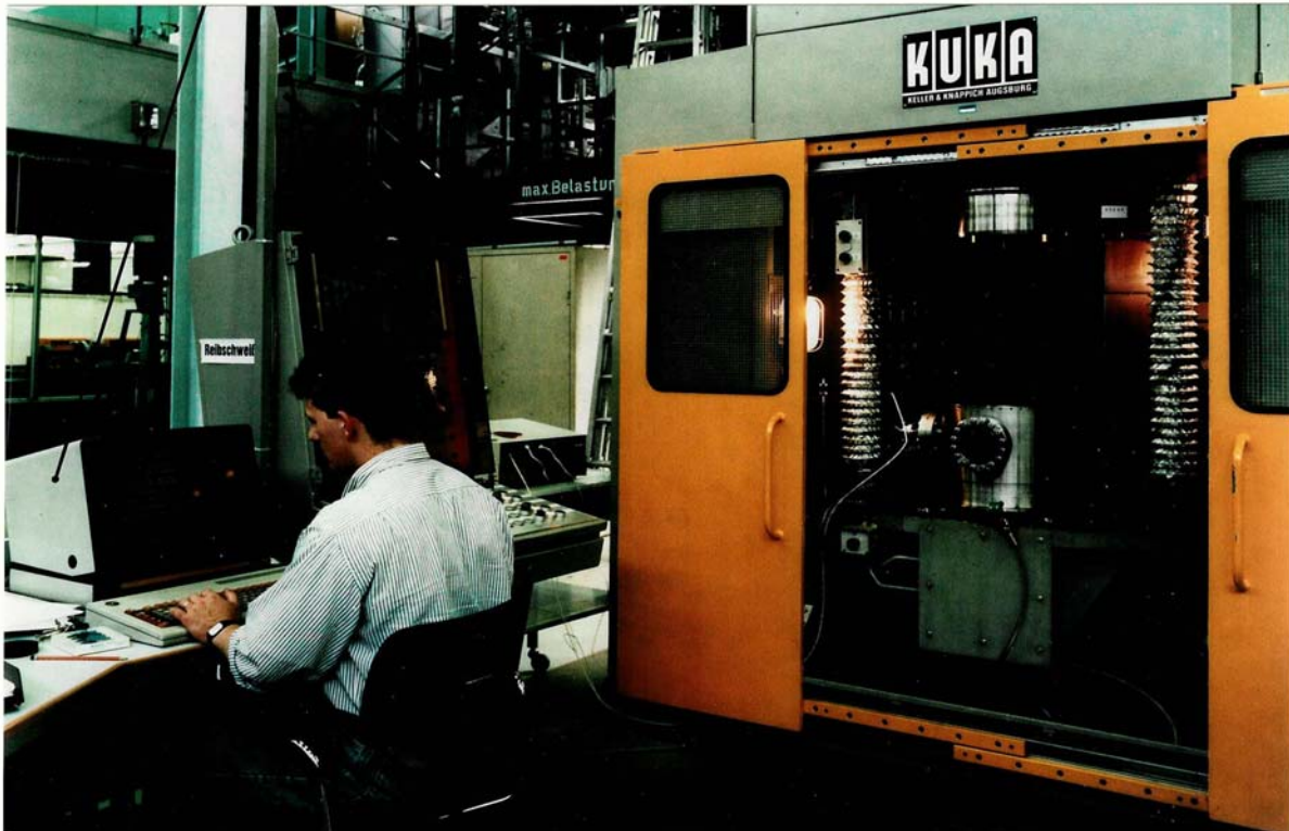
Bild 4. Versuchseinrichtung mit Reibschweißmaschine
