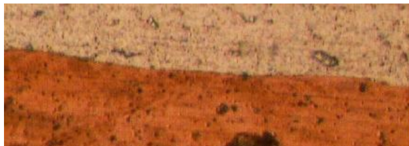
Bild 7: Durch impulsmagnetisches Schweißen hergestellte Fügeverbindung zwischen Kupfer und Aluminium, Quelle: Pulsar Ltd., Yavne, Israel
