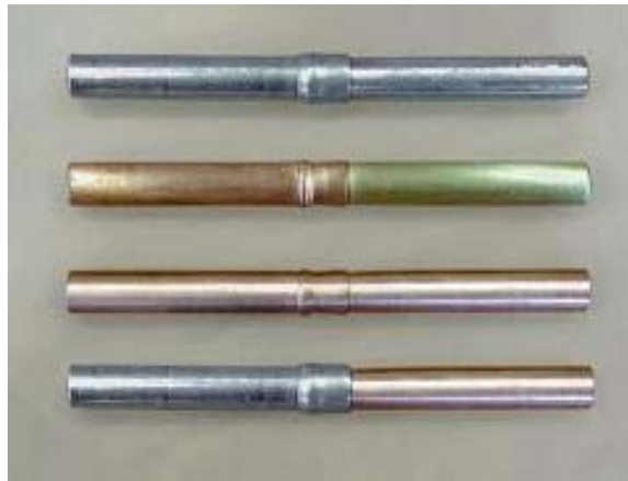
Bild 6: Fügen von Leitungen aus unterschiedlichen Werkstoffen Quelle: Pulsar Ltd., Yavne, Israel
