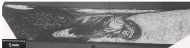
Abbildung 5: Makroschliff FSW-Schweißverbindung GDAISi 10 Mg / AlMgSi 0,5
